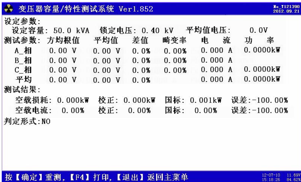
图 18、三相空载测试结果
