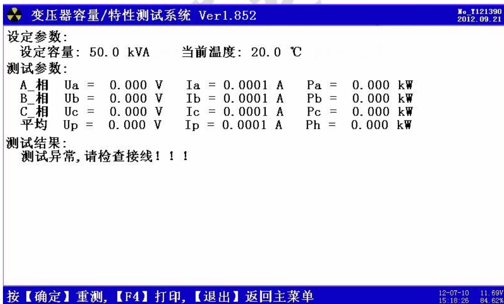
图 11、有源负载测试异常，警示界面
