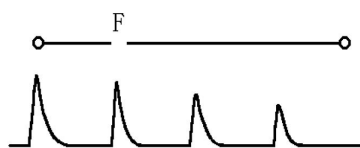
图 3-2-2 断线故障反射波形
