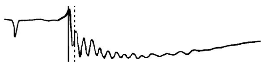
(c) 近距离故障冲闪法波形
