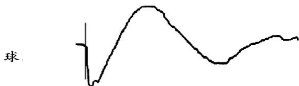
(d) 极近距离端头故障直闪法波形
