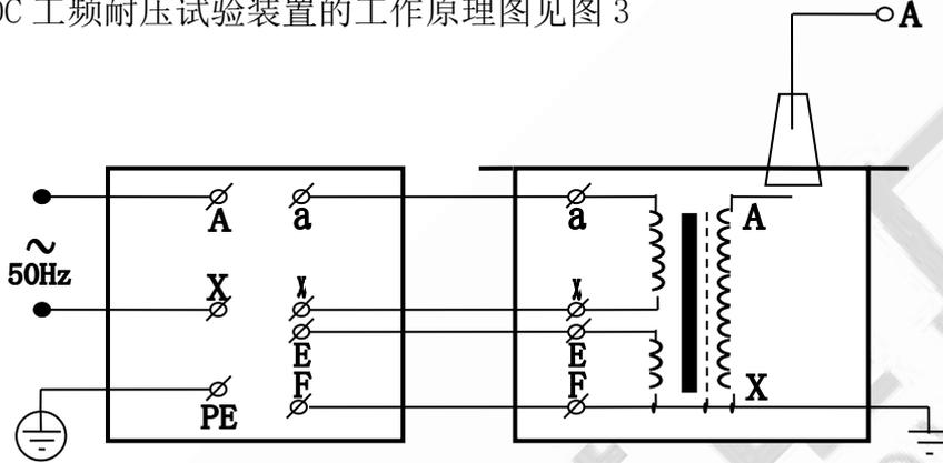
图 3：单台 YDC 工频耐压试验装置原理图
