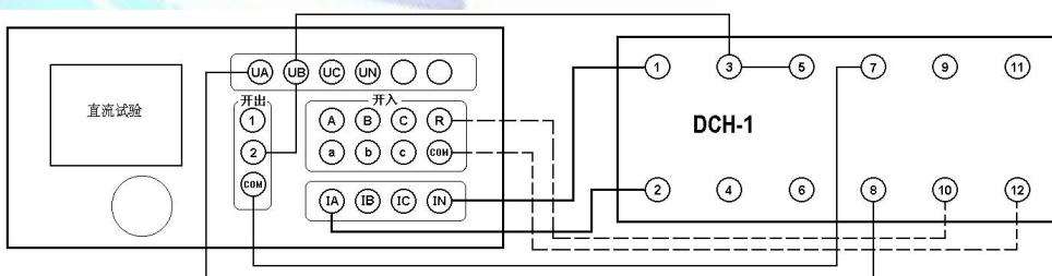
而启动重合闸。待重合闸时间到，接点动作，即可测出动作时间。
