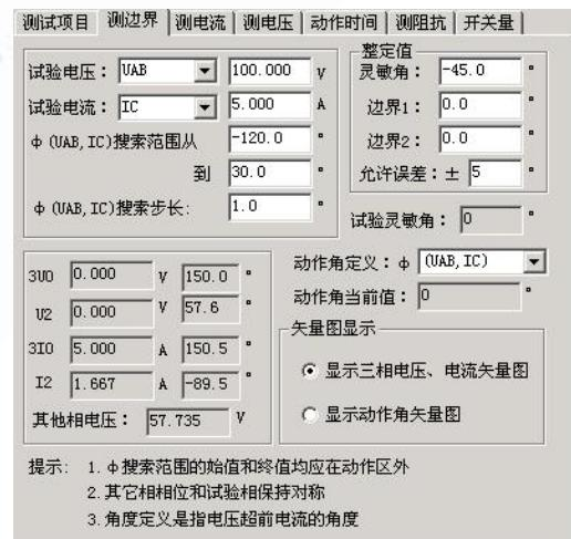
搜索开始时保护不动作，当角度变化到某一值时保护动作，即认为找到一个动作边界，并在图中划条线，然后立即转换搜索方向搜索另一个边界角（备注：此时测试仪输出的起始角度就是所设置的“搜索终值”）。当搜索出第二条动作边界时，软件再次划线。在计算出最大灵敏线后，软件自动在图中标出最大灵敏线。
