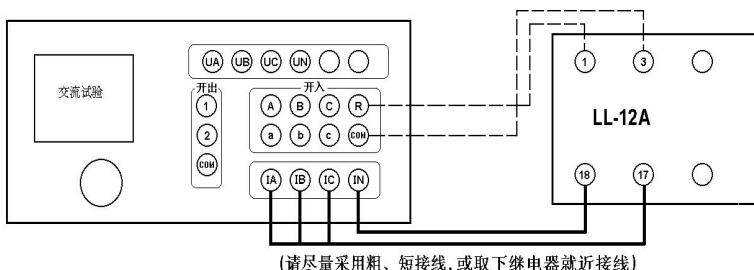
返回值及动作时间和返回时间，计算返回系数。下图为 LL-12A 过电流继电器的接线图。
