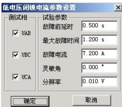
“故障电流”和“最大故障时间”均应分别大于待试验段过流保护的相应整定值。如右图所示。
