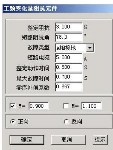
M 的值默认情况下有 0.9 和 1.1 两种设置，一般地，M=0.9 时，保护应可靠不动作，M=1.1 时，保护应可靠动作。设置 M=1.2 时，可以测出保护的动作时间。点击界面中“提示”按钮可以获得更多提示。
