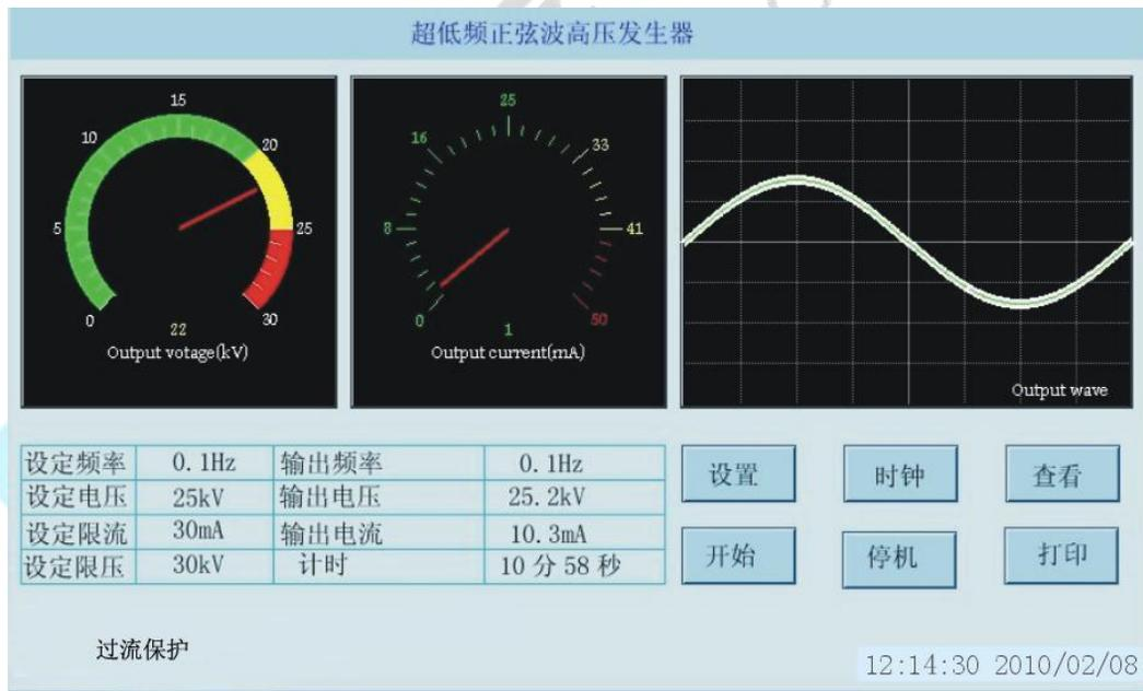
图 13 过流保护示意图
